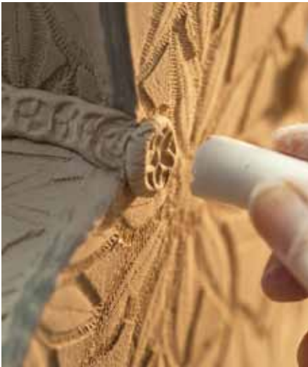
Mit den Wülsten verbindet die Keramikmeisterin die Porzellanplatten. Anschließend setzt sie mit dem Stempel eine Verzierung auf.
